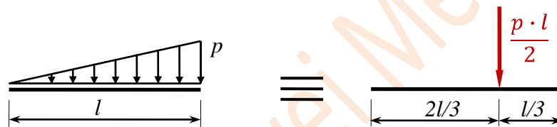
Fig. 9.10. Forța concentrată echivalentă unei forțe distribuite triunghiular
